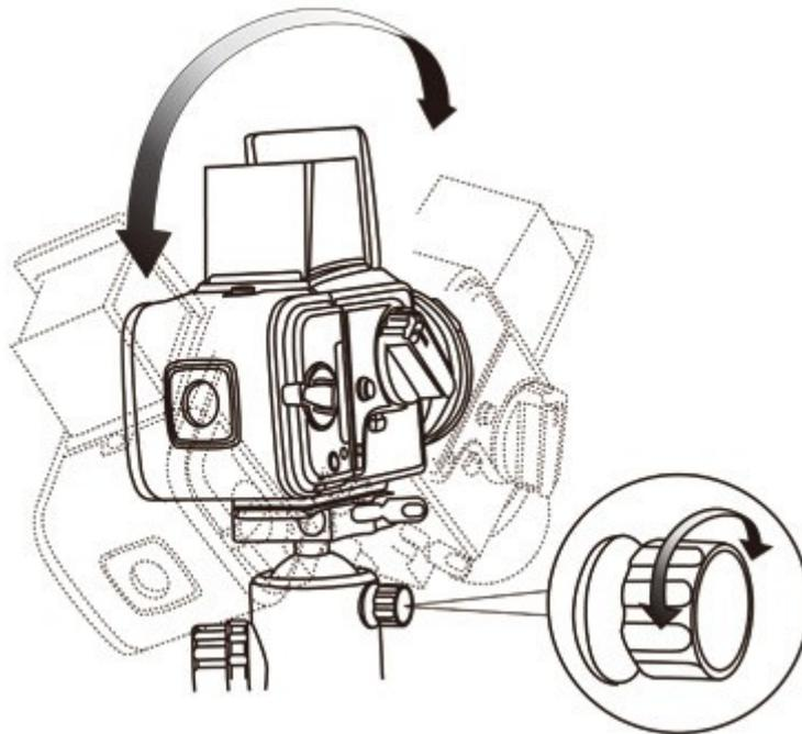
Durch Festziehen des Neigen/Tilt Knopfes ist es möglich, die Rotation und das links/rechts- Neigen der Kugel zu sperren. Somit kann die Kugel nur noch vertikal geneigt werden. Durch diese Hilfsfunktion und die panorama-Bodendrehung kann der Centerball nun als 2D- Neiger benutzt werden. Die Belastung zur horizontalen Drehung des Centerballs ist hierbei jedoch durch den O-Ring begrenzt. Bei Beschädigung des O-Ringes muss dieser sofort ersetzt werden.
