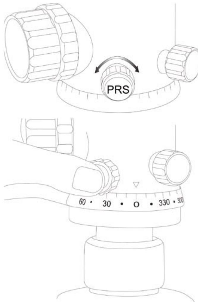
Alle FT-Modelle können später mit dem neuen PRS-System nachgerüstet werden. Die Rastfunktion des PRS-Knopfes wird durch die Rechtsdrehung der grauen Rändelschraube bis zum Anschlag aktiviert. (Bild 1)
